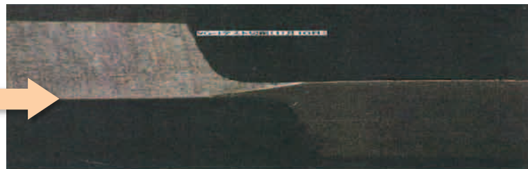
AGAIN 改質クーラント 摩耗幅 9.72 μm
