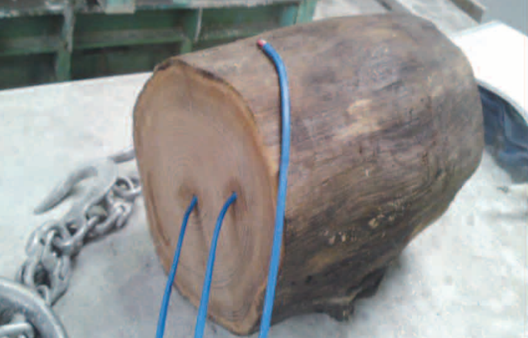
改質蒸気による木材乾燥テスト
